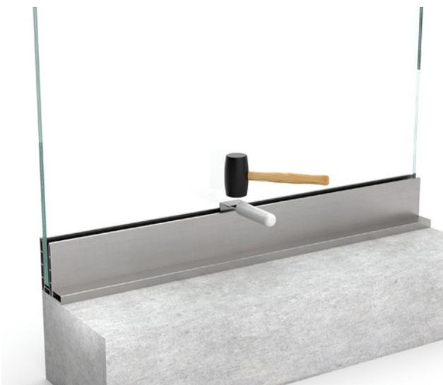
Wenn alle Keile an Ort und Stelle sind, verwenden Sie einen Keileinsetzer und einen Hammer, um sie einzuführen, bis das Glas verriegelt ist.
