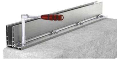
2. Profil platzieren und sichern mit einem auf 40 Nm eingestellten Drehmomentschlüssel.
