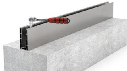
2. Profil platzieren und sichern mit einem auf 40 Nm eingestellten Drehmomentschlüssel.
