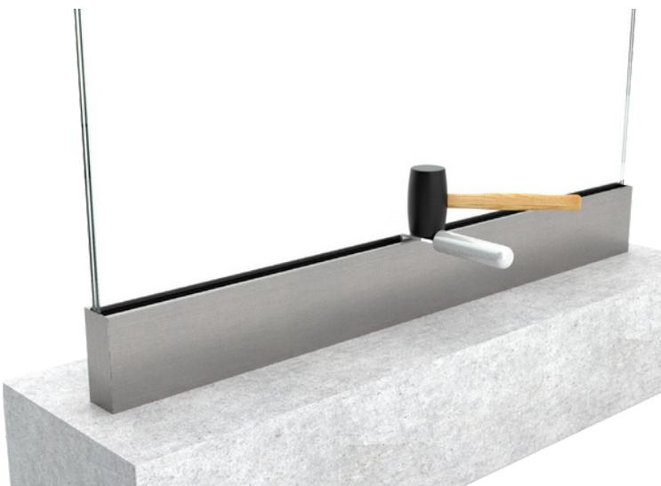
Wenn alle Keile an Ort und Stelle sind, verwenden Sie einen Keileinsetzer und einen Hammer, um sie einzuführen, bis das Glas verriegelt ist.
