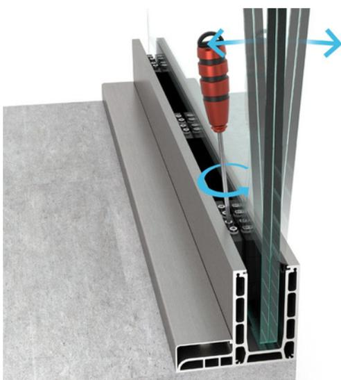
Das Erreichen einer perfekten Glasausrichtung ist einfach. Die beiden Schrauben ohne Unterlegscheibe neigen das Glas zu Ihnen, und die beiden mit Unterlegscheibe neigen es in die entgegengesetzte Richtung. Wenn eine perfekte Ausrichtung erreicht ist, ziehen Sie alle anderen Schrauben fest.
